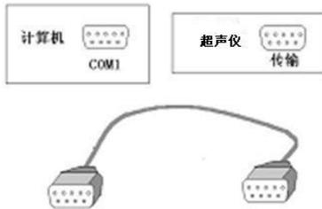
图 8.15 接线方式示意
