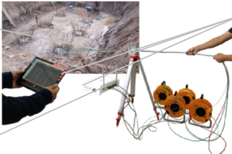
3、依次打开主机、提升装置、平板电脑电源开关，操作采集软件、提升换能器开始采集
