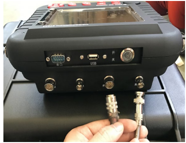
图 2.12 连接信号线到主机
