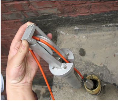
图 2.7 将探头下放到声测管
