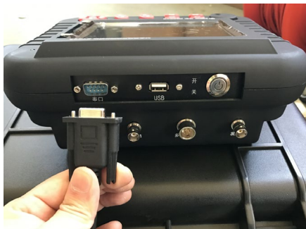
图 2.5 连接仪器控制线
