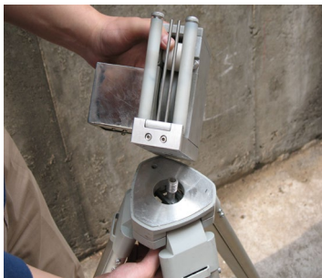
图 2.4 将提升装置固定在三脚架上
