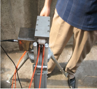
图 2.11 锁压信号线到提升装置上
