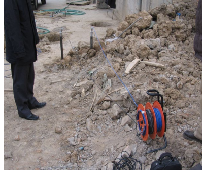
图 2.8 将探头下放到声测管
