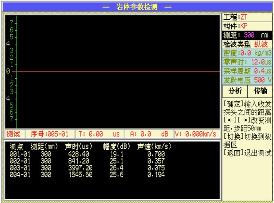
图 5.1 岩体参数测试主界面
