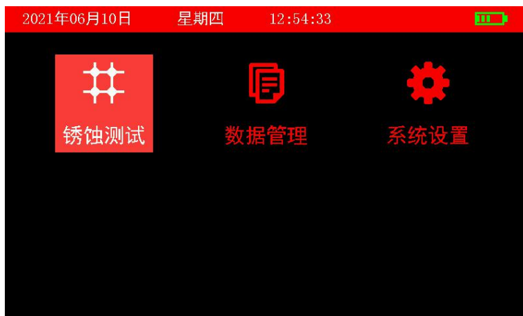
图 3.13 钢筋锈蚀功能选择界面
