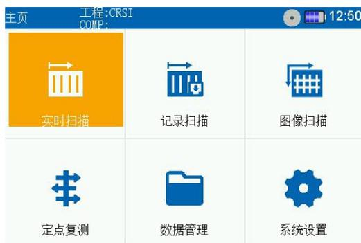
在主菜单和对话框中，您不必触摸触摸屏，只需按下‘
