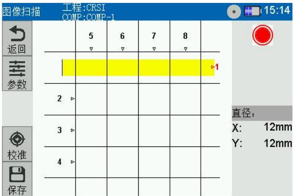
4. 沿着座标网格指示的路径将扫描仪移到要检查的区域。按照正确的顺序扫描所有路径。扫描进度通过显示屏上的进度条指示。如果扫描仪移动太快，则扫描中断并将重新扫描路径。
