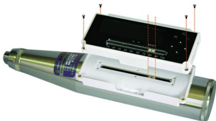
② 统一定位指针块到80刻线处,将数据采集电子仓扣好,用四颗螺丝钉锁紧在传感器底座上。
