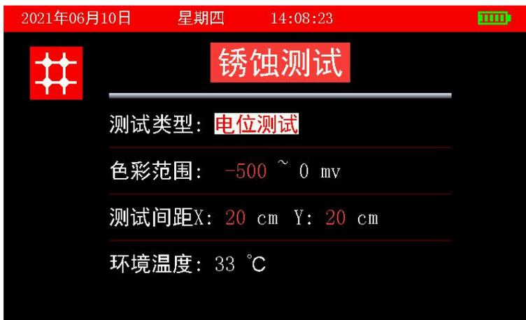
图 3.5 锈蚀测试参数设置界面
